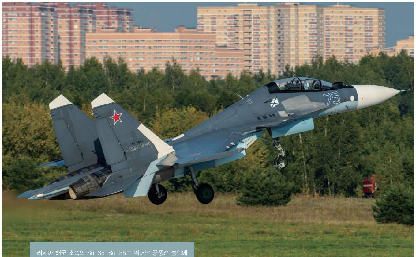
러시아 해군 소속의 Su-35. Su-35는 뛰어난 공중전 능력에 정밀 유도무기를 사용한 지상공격 능력이 추가된 다목적 전투기로 카나드(canard)와 공중급유장치의 추가, 신형 레이다 장착, 디지털 방식의 플라이바이와이어(fly-by-wire) 시스템이 적용되었다.
