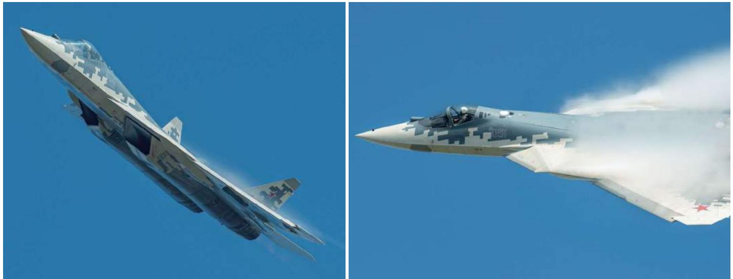
러시아의 본격적인 5세대 전투기로 제공권 장악과 적지 중심 공중 지원 전투기의 성격을 띤 Su-57은 러시아 공군이 개발 및 도입을 실시하는 최초의 스텔스 전투기라는 의미를 갖는다. 대략적인 제원은 전장 22m, 전폭 14,2m, 전고 6,05m이며 최대이륙중량은 37,000kg, 최고속도 마하2, 항속거리 5,000km, 실용상승한도 20km, 내부 무장장 6개, 외부 파일럿 6개이다.
